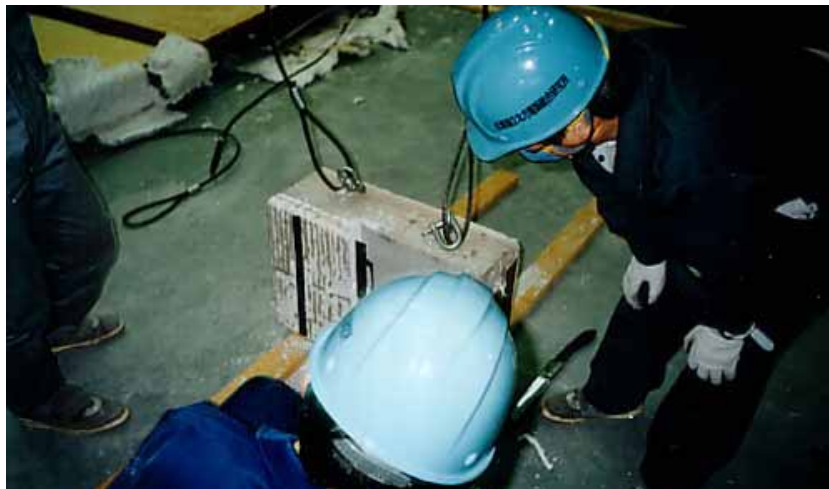
非加熱側の断熱材 強制剥離 目視観察
