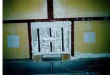
試験体の設置、加熱状況
