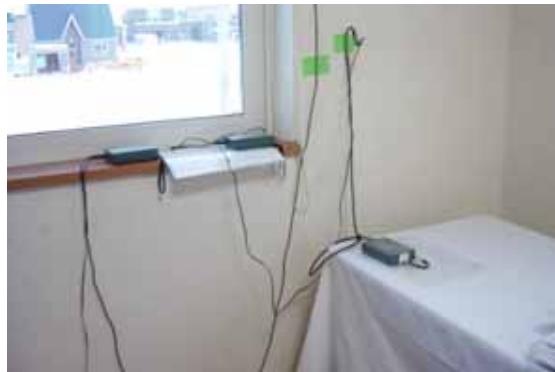
コンクリートの各部の温度を継続測定
