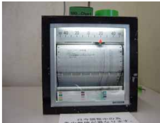
コンクリートの各部の温度を継続測定
