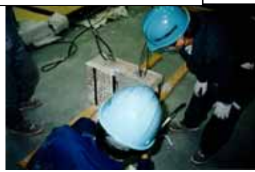
非加熱側の断熱材 強制剥離 目視観察
