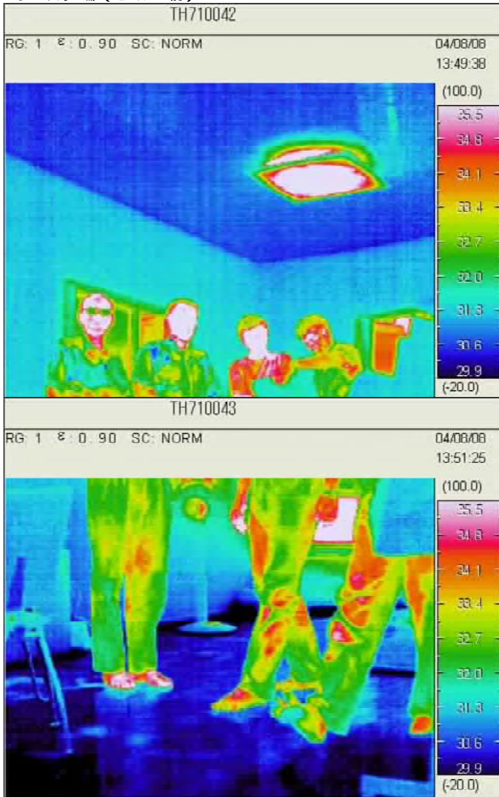
図7-1 無冷房・窓開放のモデル住宅の1階の天井面(上)・床面(下)【ひじり野5邸】 外気は32℃,天井面は29.9℃,壁面は31℃,床面は30℃。床面の温度が低いので足裏から体温が逃げるので快適だ。また,天井面の温度も低いので頭もすっきり。コンクリートは夏は熱を吸い続ける能力があるので,快適な環境になる。
